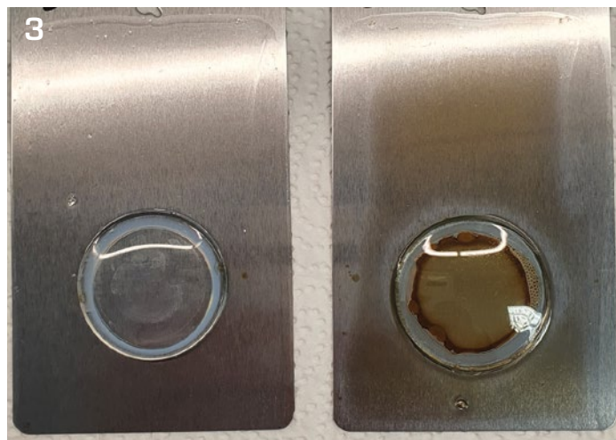
Abb. 1 // Flugrost auf einem mit Wasserlack applizierten Stahlblech. Abb. 2 // Extreme Langzeitkorrosion auf einem mit Wasserlack applizierten Stahlblech nach Salzprühtest. Abb. 3 // Test in einem wässrigen Klarlack, der Dosierungsgrenzen des Flugrostinhibitors „flashproTAC F2M“ bei verschiedenen Konzentrationen auf Stahlblechen im Uhrglasstest zeigt. Abb. 4 // Laufender Bucket-Test: Versuchsaufbau mit Kamera- und Zeitraffer.
