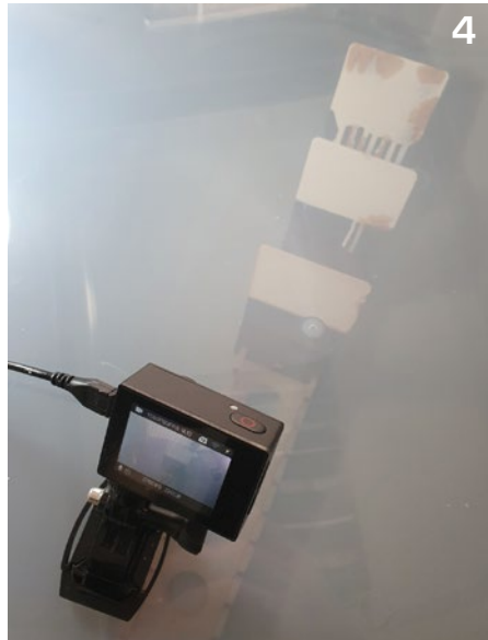
Abb. 1 // Flugrost auf einem mit Wasserlack applizierten Stahlblech. Abb. 2 // Extreme Langzeitkorrosion auf einem mit Wasserlack applizierten Stahlblech nach Salzprühtest. Abb. 3 // Test in einem wässrigen Klarlack, der Dosierungsgrenzen des Flugrostinhibitors „flashproTAC F2M“ bei verschiedenen Konzentrationen auf Stahlblechen im Uhrglasstest zeigt. Abb. 4 // Laufender Bucket-Test: Versuchsaufbau mit Kamera- und Zeitraffer.
