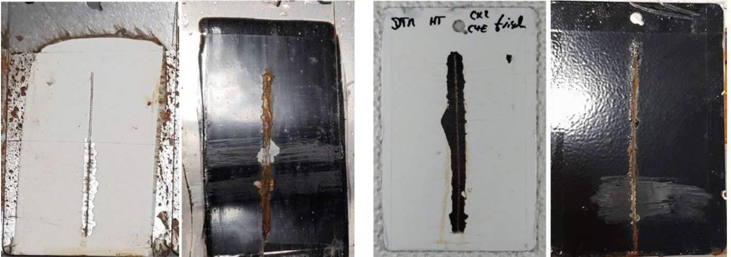
Abb. 5 (links) // Auswertung nach 24 h SST wet adhesion Test; links: High TAC Inhibitorvergleich, wässrige 1K DTM Acrylat/Styrol Beschichtung weiß auf blankem Stahl; rechts: Zinkphosphataustausch, lösemittelhaltige 2K High Solid Acrylat Beschichtung schwarz auf blanken Stahl. (rechts) // Auswertung nach 500 Stunden Salzsprühstest; Proben wie oben.
