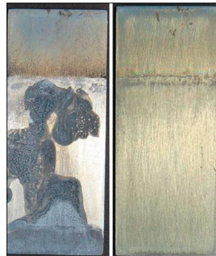
**Abb. 3: Korrosionsschutzeffekt einer polymeren Inhibitorschicht auf Zink**
